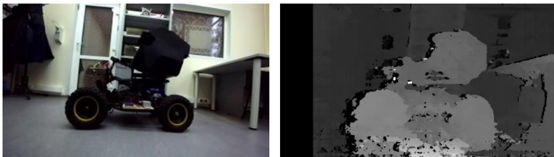
Рис. 3. Пример карты глубины со стереокамеры. Слева исходное изображение, справа на его основе карта глубин
