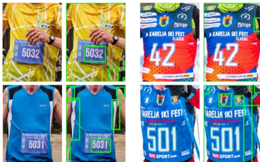
Рис. 2. Локализация номера пороговыми методами
